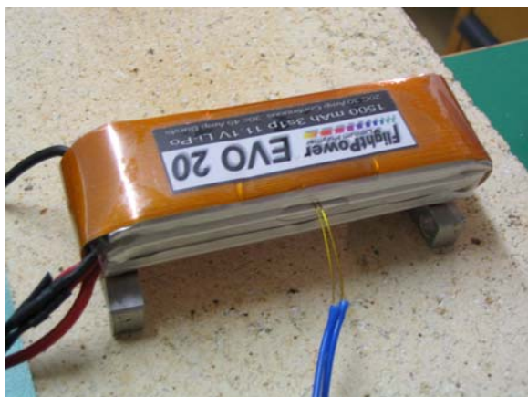
Montage des Temperaturfühlers
